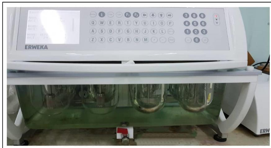
**Figure II-13:** Photo du dissolu-test ERWIKA -Université de Blida 1
