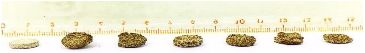
Figure IV.13 : effet du gonflement (pH 1.2) sur les comprimés de (200-300 \mu\text{m} ) jusqu'au 7 min d'étude.
