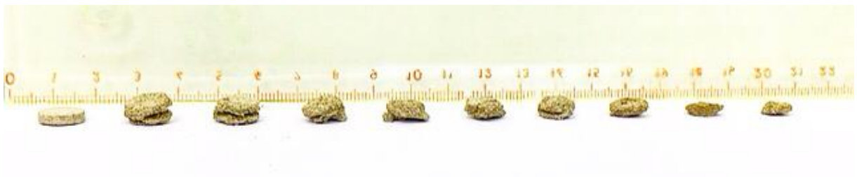
Figure IV.12 : effet du gonflement (pH 1.2) sur les comprimés de (100-200 \mu\text{m} ) jusqu'au 10 min d'étude.
