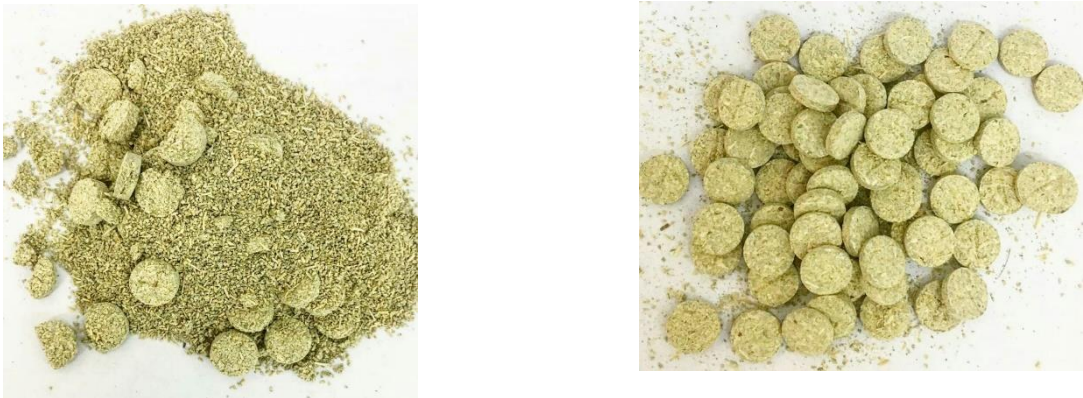
Figure IV.11 : Différence entre les Cp de (500-630 \mu\text{m} ) aux forces de compressions 13 et 14 kN
