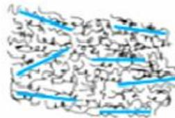
**Figure I.14** : Structure d'un nanocomposite exfolié.
