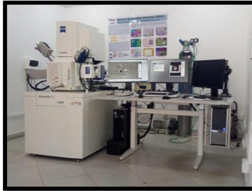
**Figure II. 9:** Appareillage de microscope électronique à balayage « ZEISS Gemini SEM 300 ».
