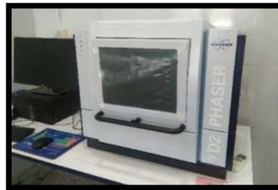
**Figure II.8 :** Diffractomètre à rayons X de paillasse « BRUKER D2 PHASER 2G ».
