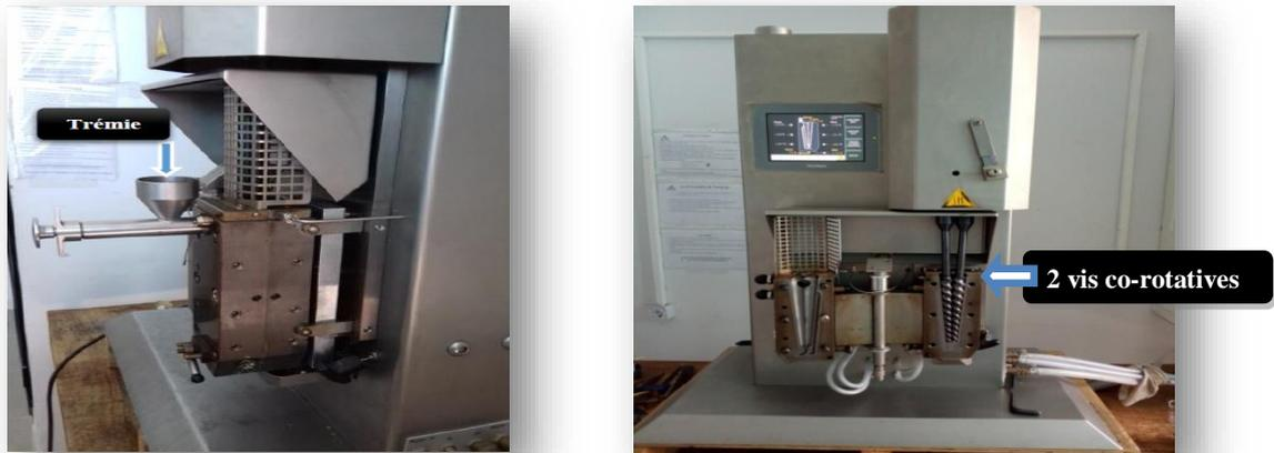
**Figure II.5 :** Mini-extrudeuse de marque Micro Compounder DSM Xplore Modèle 2005.
