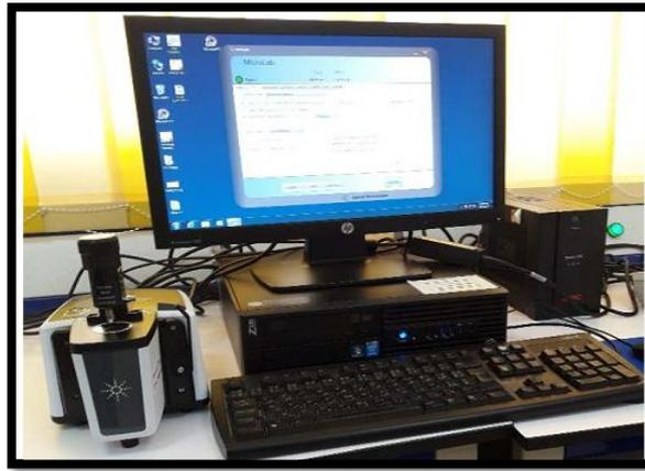
**Figure II.6 :** Appareillage du spectromètre « FT-IR-ATR » associée par microordinateur.
