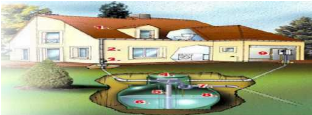
Figure 22 : système de récupération des eaux de pluie
