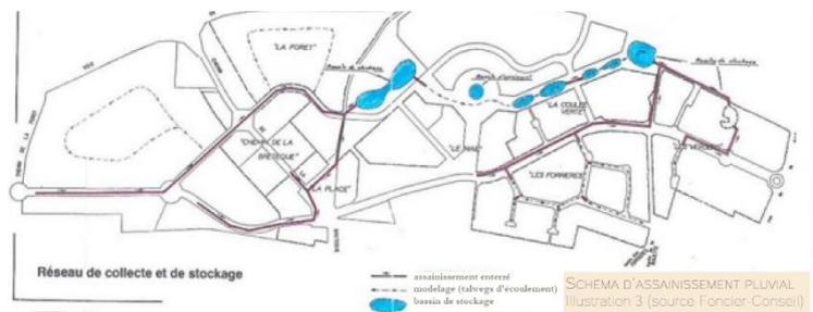
Fig : 33 Le plan d'assainissement pluvial
