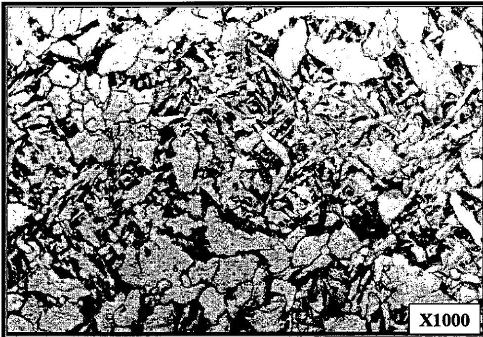
Fig. 41: Structure Ferrite + Pearlite + Ferrite aciculaire après forgeage à 1100 °C / Eau, Nuance A (0.40%Mo). HV = 260
