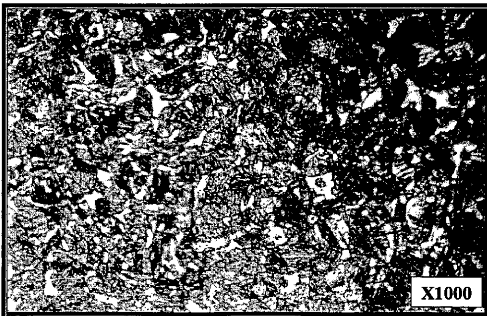
Fig. 33: Structure Martensite + faible quantité de Ferrite après trempe à 850 °C, Nuance B (0.60 %Mo). HV = 338
