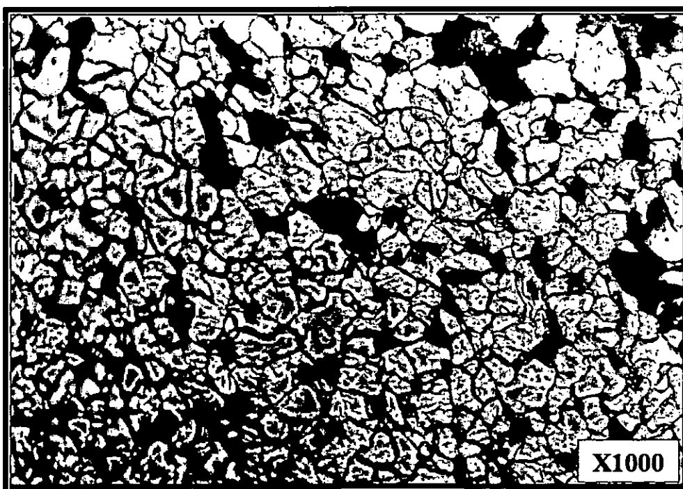
Fig. 40: Structure Ferrito-Perlitique après forgeage à 1000 °C / Air. Nuance A (0.40 %Mo). HV = 175
