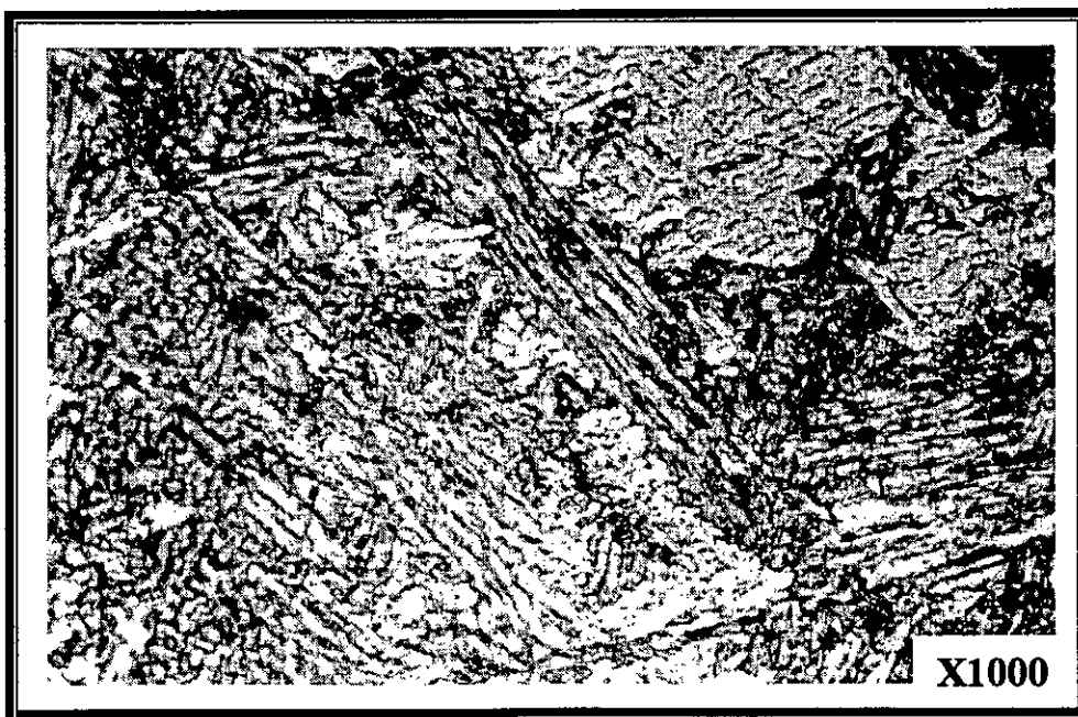
Fig. 25 : Structure de Widmanstätten à l'état brut de coulée. Nuance B (0.60 %Mo). HV = 246
