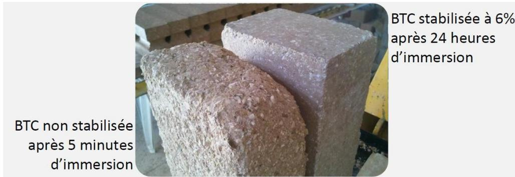
Figure 76 : différence entre un BTC stabilisée et non stabilisée
