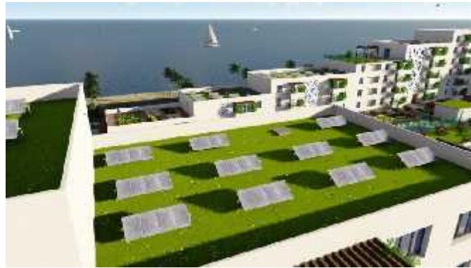
Figure II-46 : toiture végétalisée et panneaux photovoltaïque sur les toits du projet Source : auteur
