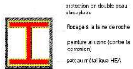
Figure II-55 : Protection de la structure contre le feu et la corrosion Source : auteur
