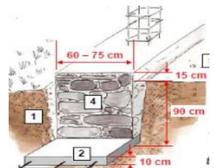
Figure 185: dalle de protection du mur en pierre Source : Tom Schacher, 2009
