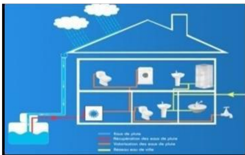
Figure 9: La récupération des eaux pluviales. Source : http://www.ecomicrostation.fr/amenagement-deau-pluvial/
