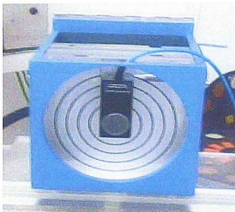
FIG.2.36. Positionnement de la chambre d'ionisation dans le fantôme en PMMA.
