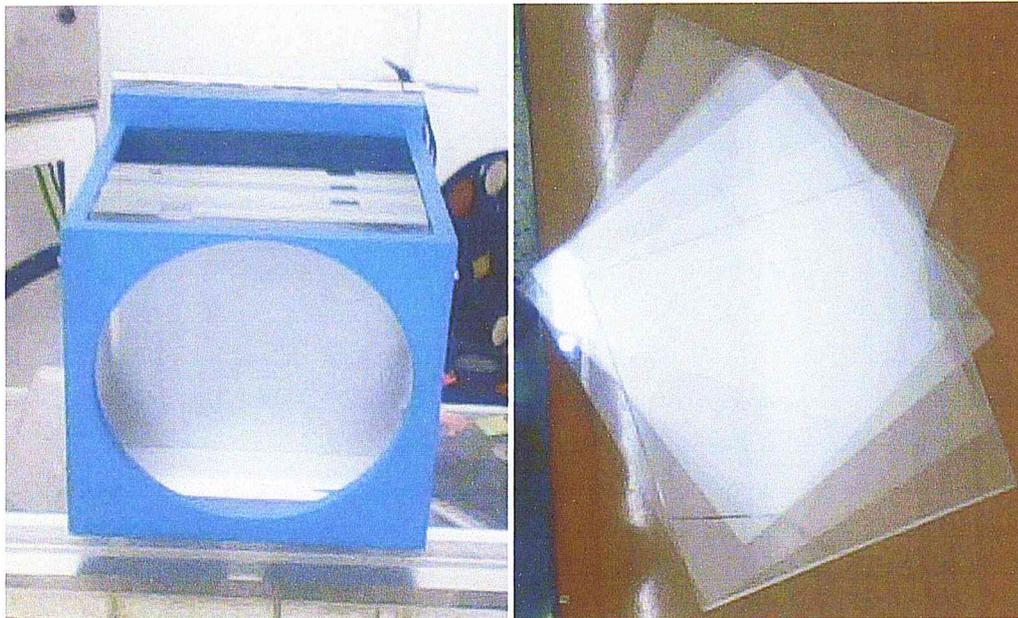
FIG.2.34. Fantôme en PMMA.
