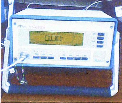
FIG.2.5. L'électromètre PTW UNIDOS.
