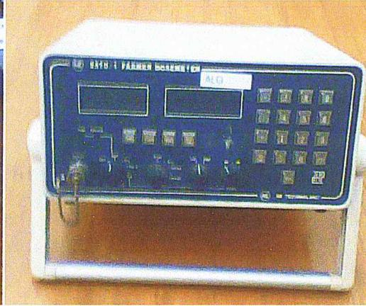
FIG.2.6. L'électromètre Farmer.
