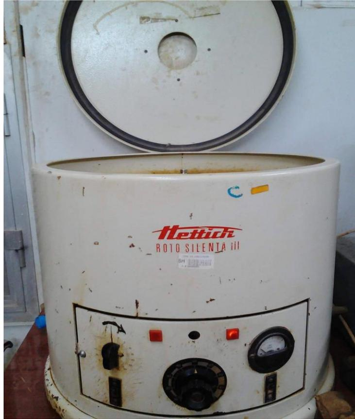
FIG-IV-11 : Centrifuge pour la mesure des teneurs en eau et sédiments BSW (%v) du brut
