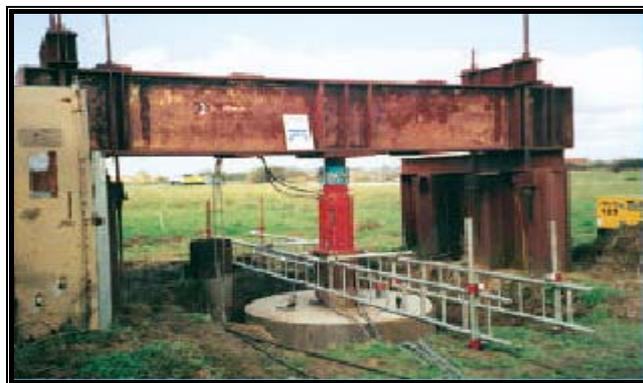
Figure 1.13 : Essai de chargement vertical d'un pieu
