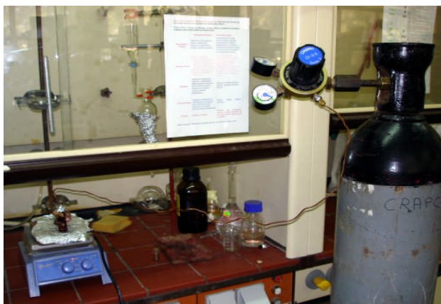
Figure 6.8 : Evaporation de l'Hexane sous courant d'azote.
