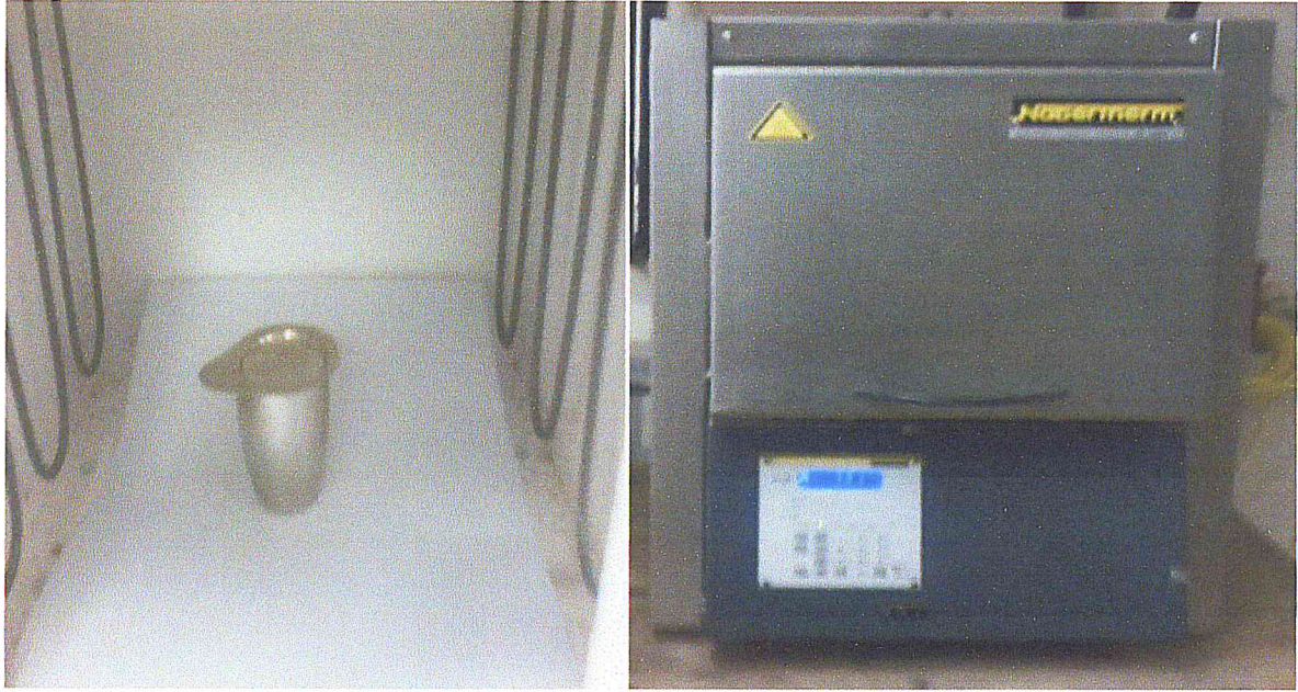
Figure II.4: Le creuset avec le mélange vitrifiable dans le four pour la fusion.
