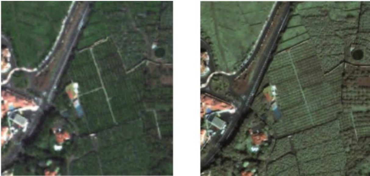
Figure 1.3: Des images qui expriment une différente résolution spatiale: 2 m/pixel (à gauche) face à 0,5 m/pixel (à droite). Source: SATELMAC [6].
