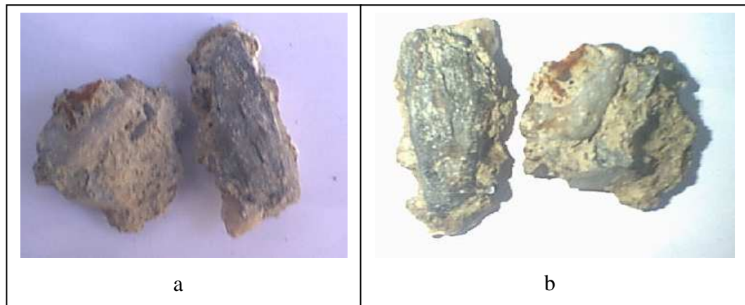
Figure III-6 Test de phénolphtaleine (ouvrage privé), la figure (a) représente l'état
