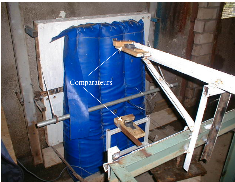
Figure 3.50 : Emplacements des comparateurs pour l'enregistrement des déplacements
