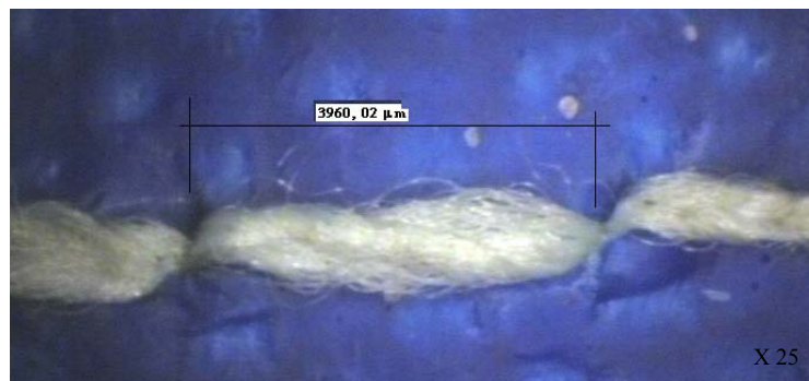
Figure 3.3 : Couture avec un pas espacé (3960.02 μm)
