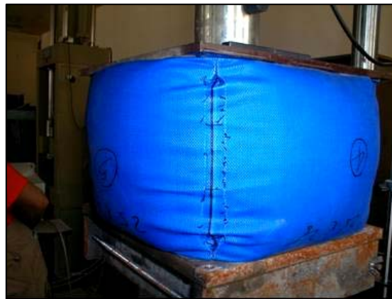
Figure 3.20 : Rupture du fil de couture au niveau de l'arête
