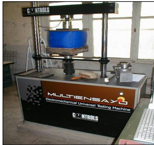
Figure 2.2 : Appareil d'essai de compression
