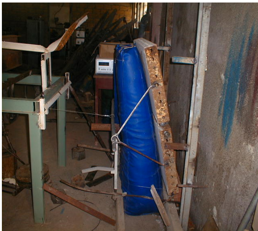
Figure 3.56 : Mur amorçant la rupture (arrachement par la base)
