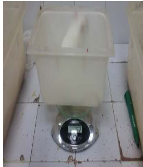
Figure 02 : Balance avec cage pour peser les animaux.
