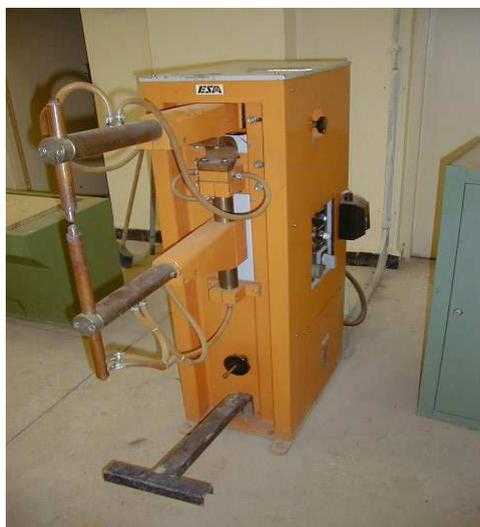
Figure 4.2 : Soudeuse par point.
