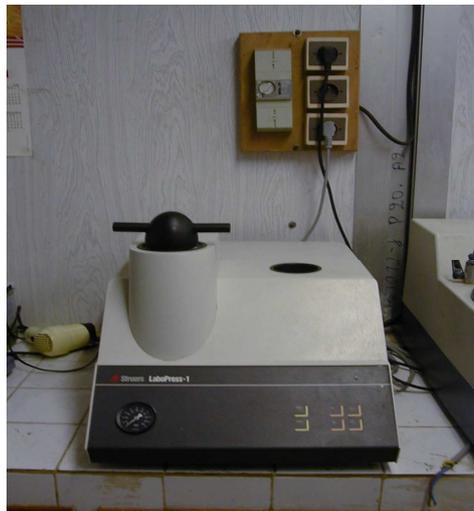
Figure 4.4 : Machine à enrober.
