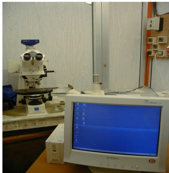
Figure 4.5 : Mécanisme de visualisation (Microscope+Micro-ordinateur).
