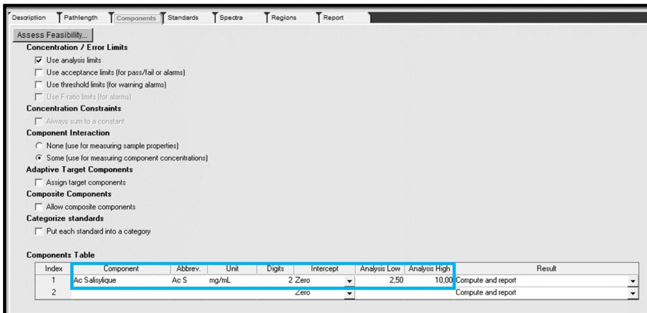
Figure 27 : Indexation du composé de l'unité de mesure et des limites d'analyses.
