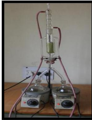
**Figure 7** : Montage Soxhlet avec double bypass [37].
