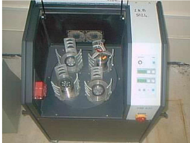
Figure 2.1 a : Broyeur planétaire, de marque commerciale Retsch PM 400 (modèle Pulvérisette 7), utilisé pour la mécanosynthèse des alliages Fe-Co.
