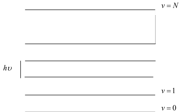
Figure. 2.5 Niveaux d'énergie pour un oscillateur harmonique.
