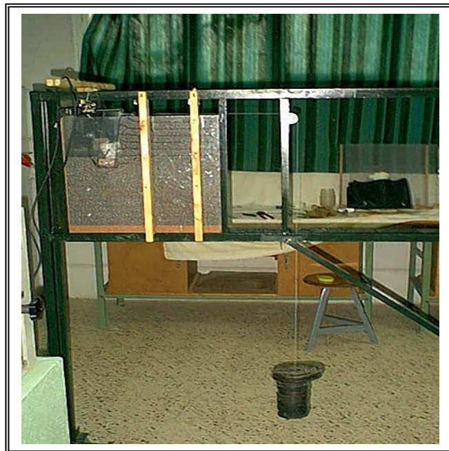
Figure 2.19 : Dispositif de chargement horizontal du mur.
