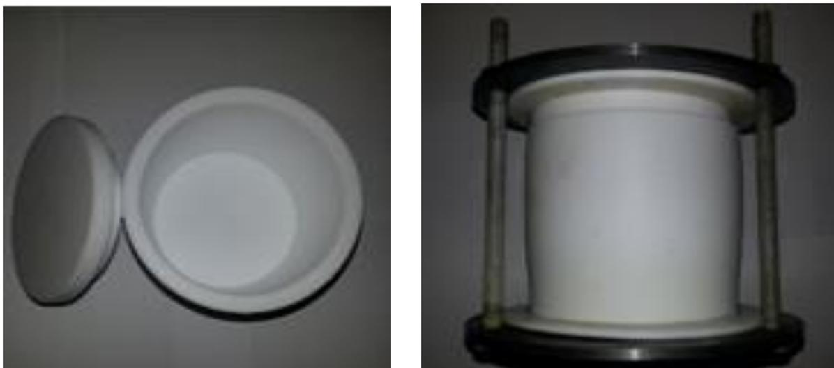
*Figure II. 1. Photos de l'autoclave : la jarre en téflon et de la jarre scellée.*
