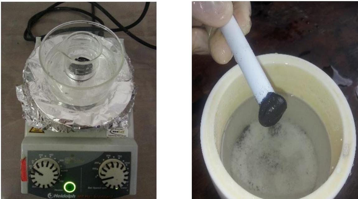
*Figure II. 2. Photos qui illustrent la récupération de la poudre par un barreau magnétique et du séchage d'échantillon.*
