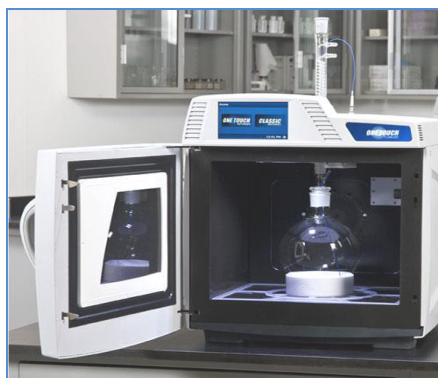
Figure I.4 : Appareillage d'extraction assistée par microondes.
