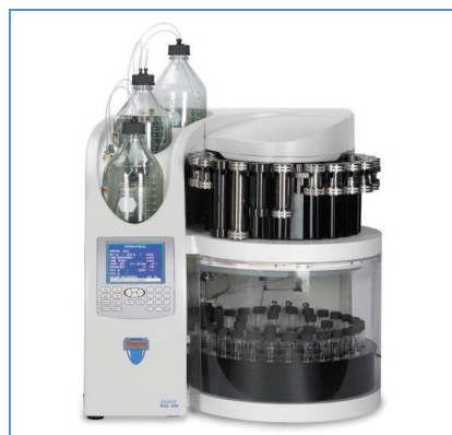
Figure I.6 : Appareillage Extraction accélérée par solvant.
