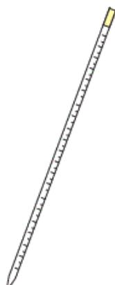
Pipette graduée ou pipette paille de 1mL
