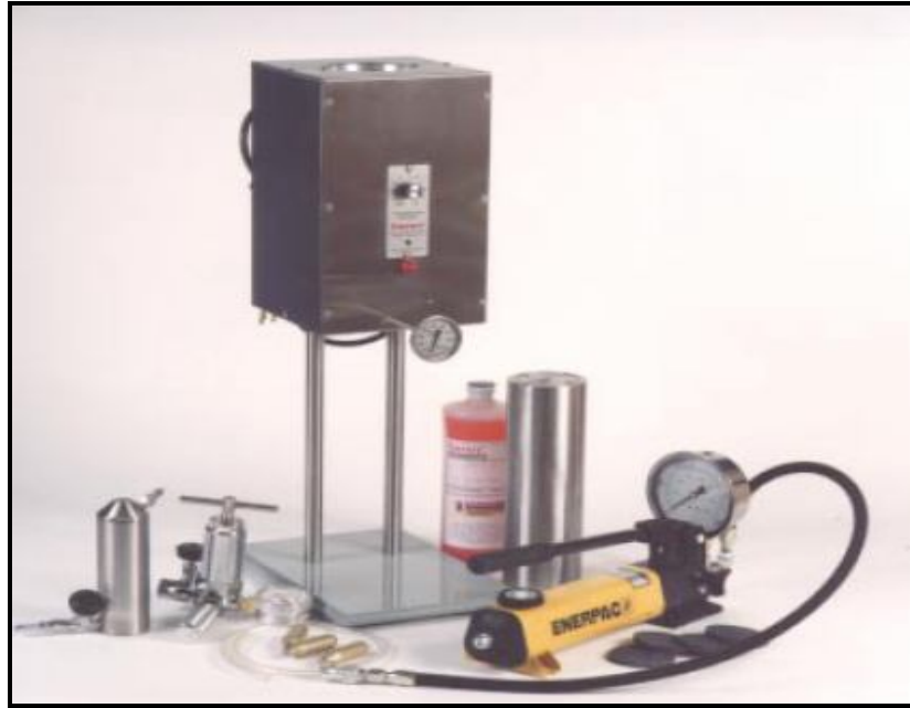
Figure 1.3 Schéma du dispositif permettant le test de percolation
