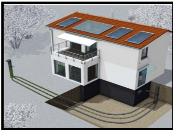
Figure 8: exemple d'utilisation d'un puits canadien
