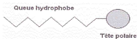
Figure2 : Représentation schématique d'une molécule de tensioactif.
