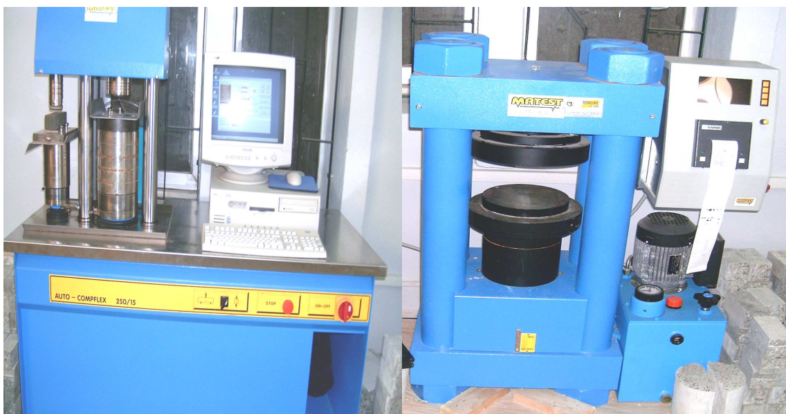
Figure 3.4. Presse de compression des éprouvettes de mortier et béton.
