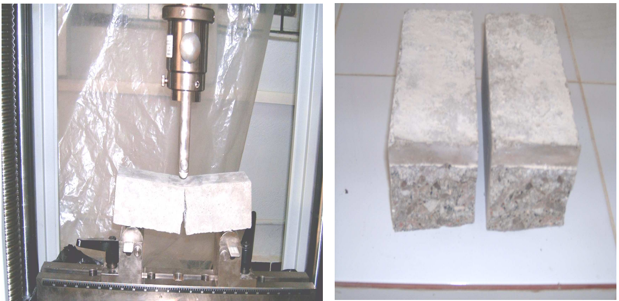
Figure 3.3. Demi prismes d'une éprouvette de béton entaillée issu de l'essai de flexion.
