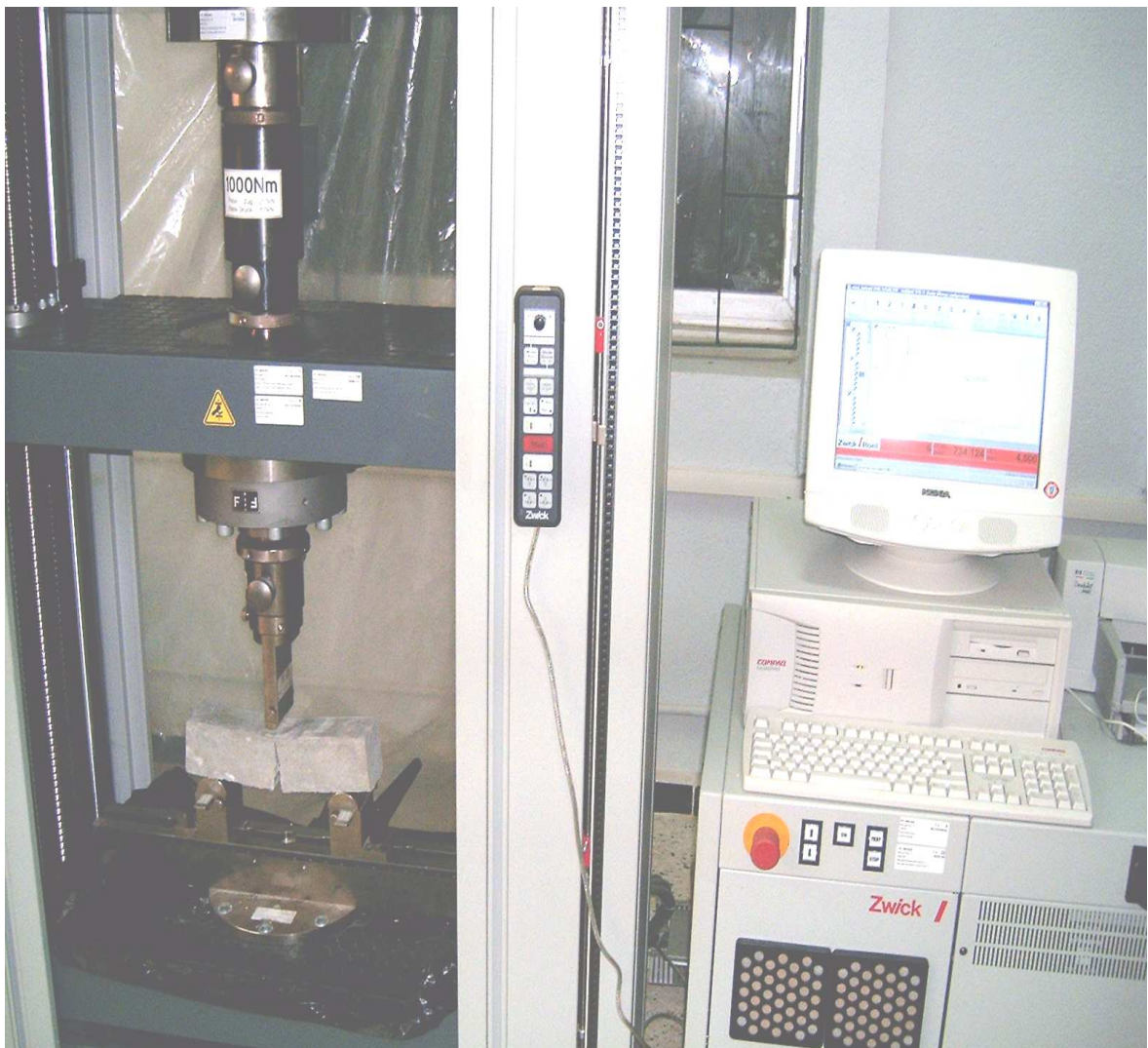
Figure 3.5. Presse de flexion trois point des éprouvettes de mortier et béton.
