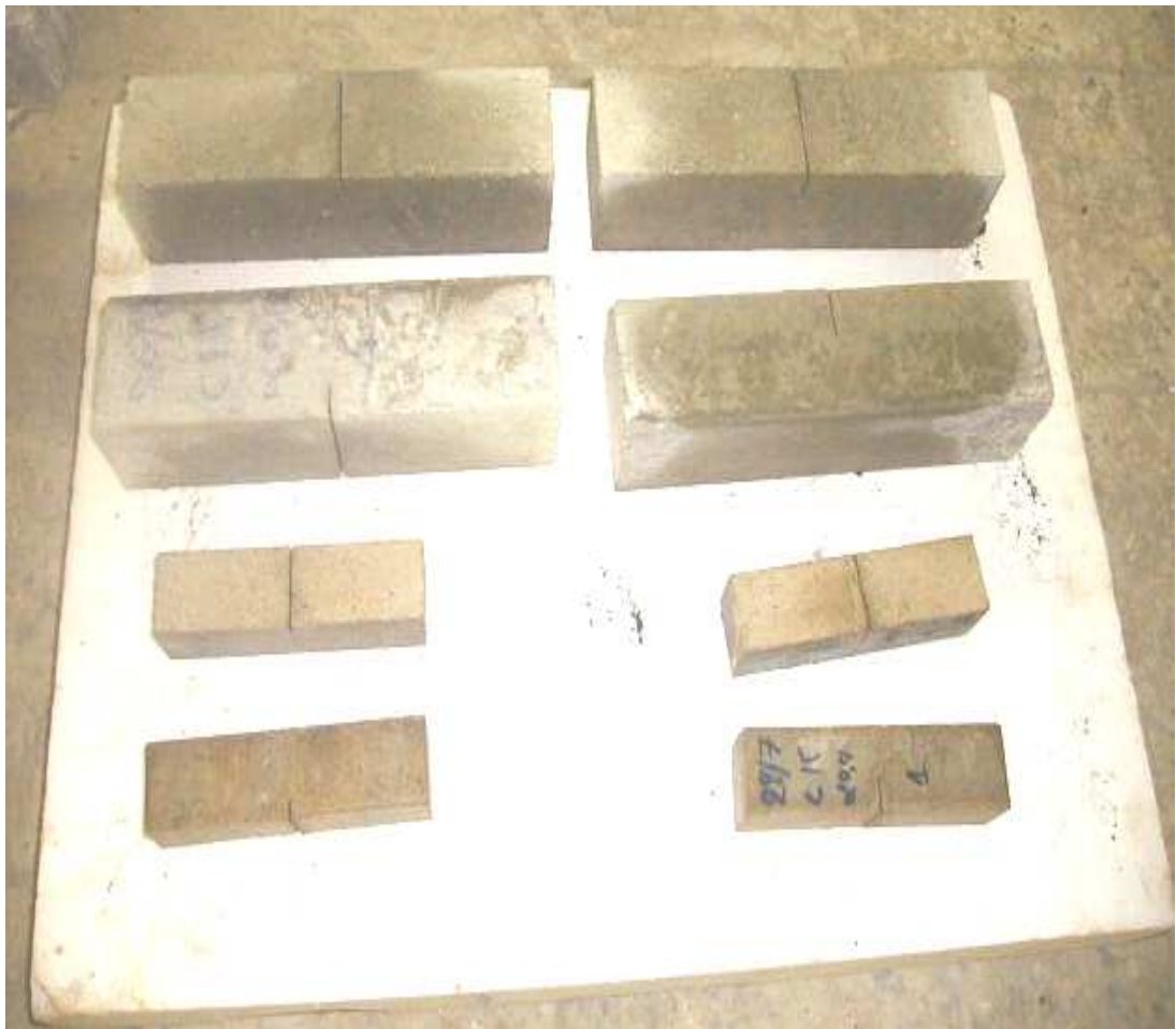
Figure 3.2. Eprouvettes de mortier et béton entaillées de différentes profondeurs.
