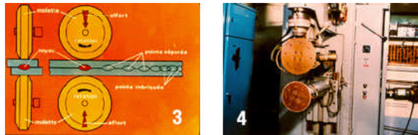
Figure 2.1.2 : Soudage à la molette : principe (photo 3)
