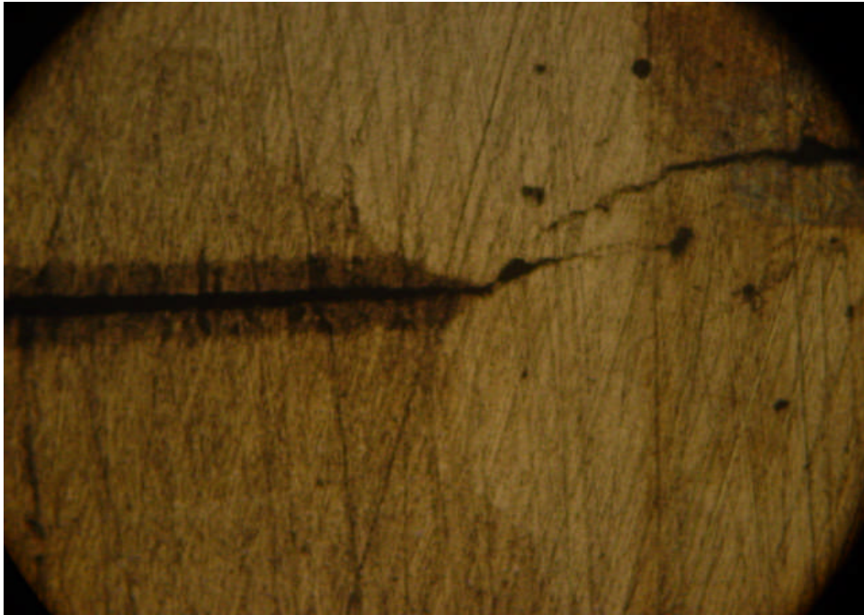
Figure 5.2 : photo du début du noyau fondue obtenue expérimentalement. Courant = 6KA, 20 cycles, F= 2000 N.
