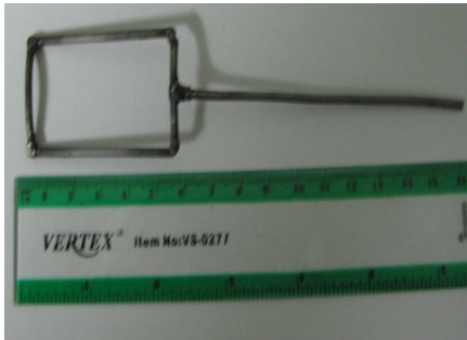
Figure 5.4 : Gabarit pour l'écouvillonnage des vannes de vidanges.
