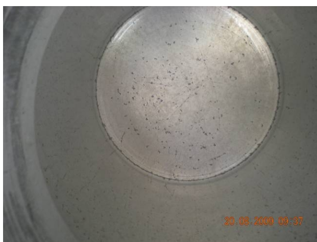
Figure 5.27 : Paroi intérieure d'un ustensile d'entreposage en aluminium avec des taches de corrosion.
