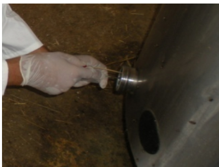
Figure 5.8 : Prélèvement à l'intérieur de la vanne de vidange.
