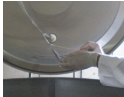
Figure 5.7 : Prélèvement au niveau de la lame de l'agitateur.
