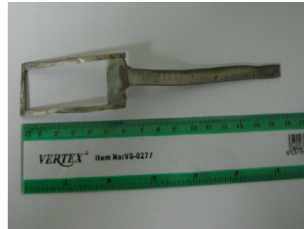
Figure 5.5 : Gabarit pour l'écouvillonnage du fond de la cuve, de la lame de l'agitateur et du fond des ustensiles
