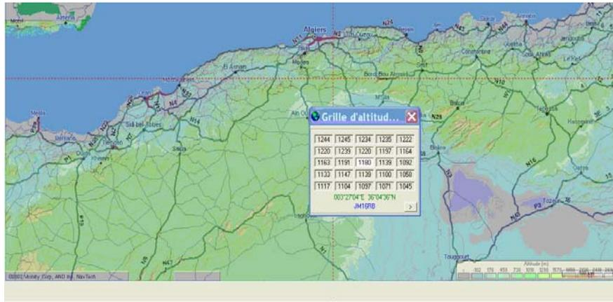
Figure 4.6 : Acquisition de la grille des altitudes sous Radio mobile pour le nord algérien.
