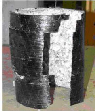
Figure 1.15 : Rupture d'une colonne carrée avec confinement en carbone [24].
