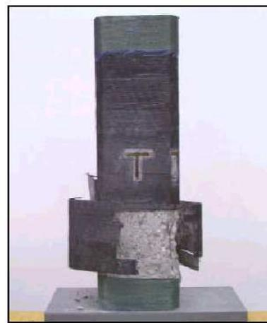
Figure 1.16 : Rupture de colonnes renforcées par des confinements en fibres d'aramide (Kevlar R) et de carbone 640 [24].
