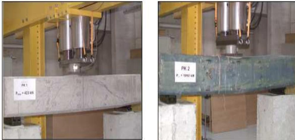
Figure 1.18 : Essais d'effort tranchant sur des colonnes en béton avec ou sans renforcements par des tissus en Kevlar R [24].
