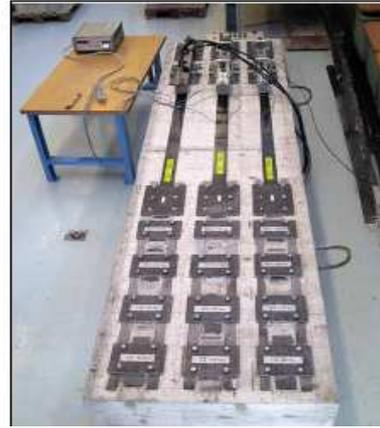
Figure 1.13 : Essais sur les ancrages des lamelles CFK [24]
