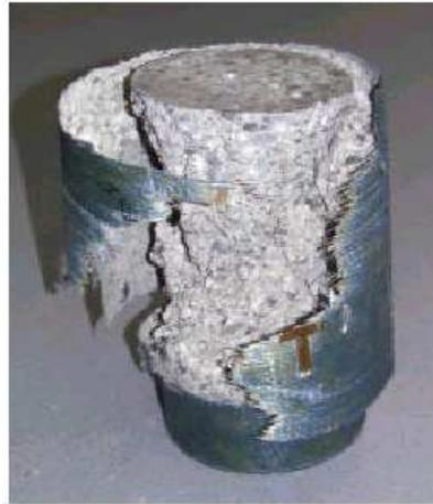
Figure 1.14 : Essais de compression sur des colonnes confinées [24].
