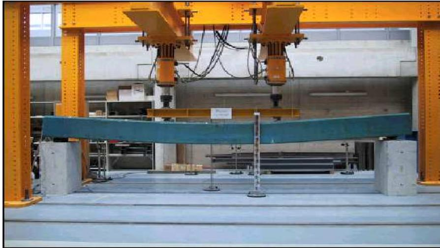
Figure 1.17 : Essais de flexion sur des colonnes renforcées de tissus en Kevlar R [24].
