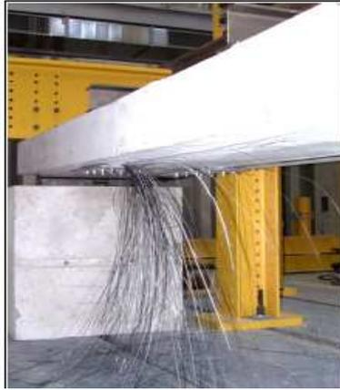
Figure 1.12 : Rupture d'une lamelle en composite CFK [24]
