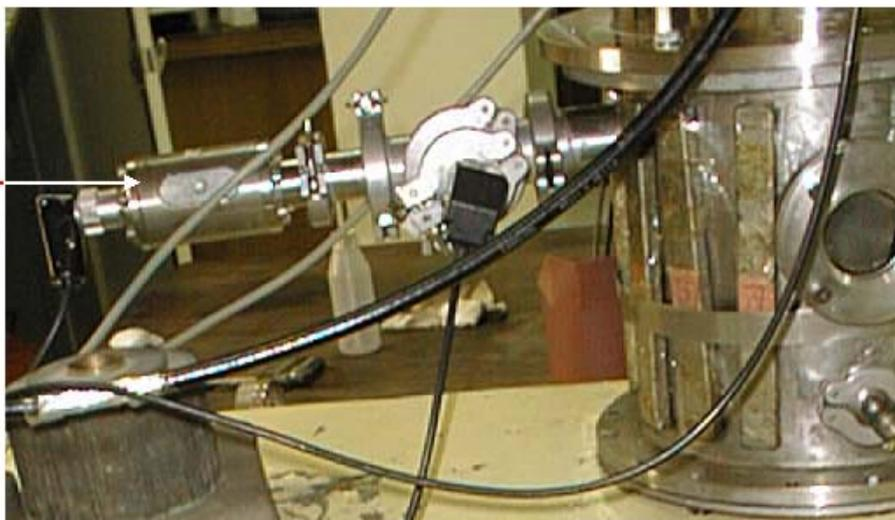
Figure 3.3 : Dispositif de mesure de la pression dans l'enceinte.
