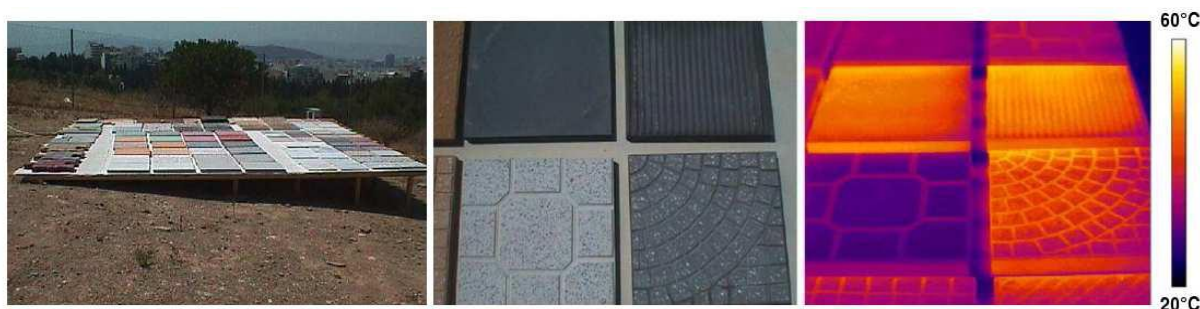
Figure II.70 : Photo et thermographies IRT des revêtements testés dans l'étude de. Source : Bouyer, Julien. Modélisation et simulation des microclimats urbains -Etude de l'impact de l'aménagement urbain sur les Consommations énergétiques des bâtiments. Thèse de doctorat : Energie électrique. Université de Nantes, 2009
