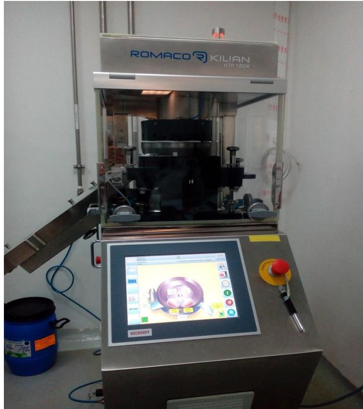
**Figure 4.5 :** vue réelle d'une presse à compriimer rotative.
