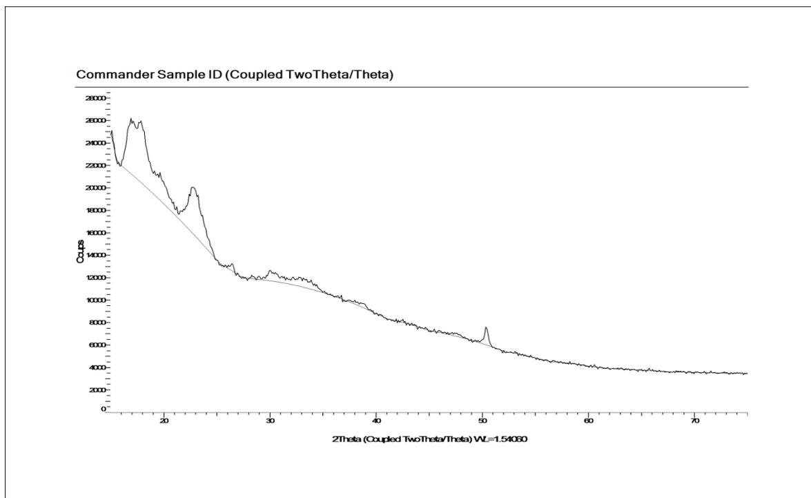
**Figure 5.7:** Diffractogramme de rayons X de l'amidon acétylé.
