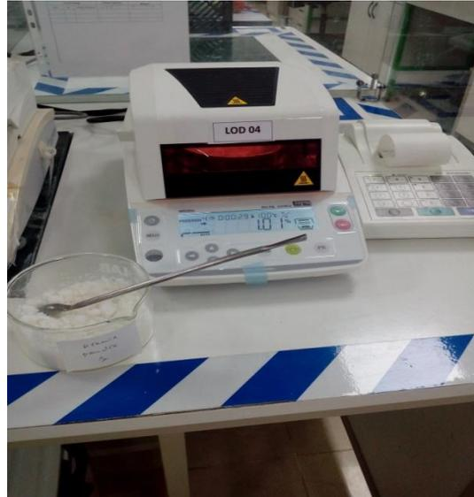
**Figure 4.1 :** photo représentant l'appareil de LOD.
