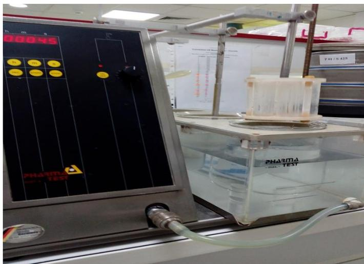
**Figure 5.8 :** photo représentant appareil du test de désagrégation.
