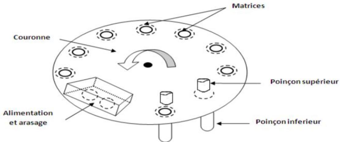
Figure 2.7 : Machine à compresser rotative [38].
