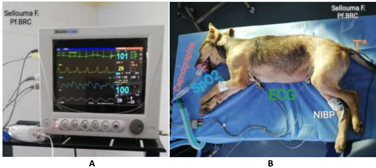
A B Photo n° 11 : A : Moniteur (Scope) multiparamétrique « EDAN iM8 VET® » B : Branchement des électrodes sur l'animal.
