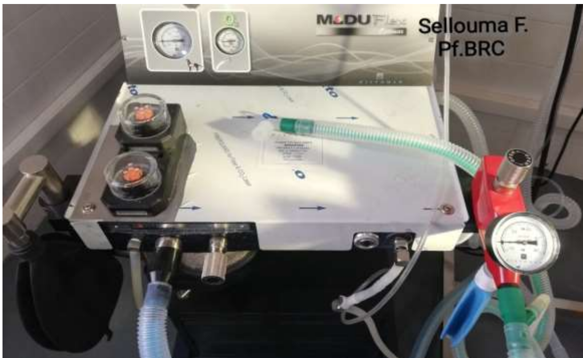
Photo n° 07 : Les deux circuits patients du MODUFLEX Optimax Coaxial ®: semi fermé dit ré-inhalatoire et semi ouvert de BAIN dit non ré-inhalatoire.
