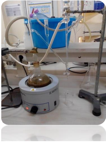
Figure.18. Hydrodistillateur de type cleveger (Originale, 2017).
