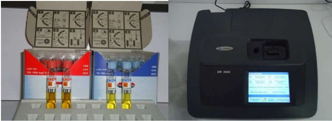
KIT HACH LCK 114/314 (gauche) et Spectrophotomètre DR 3800 (droite).
