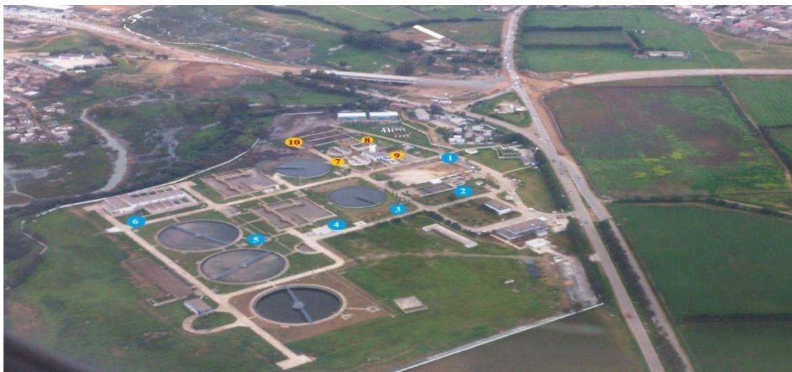
Figure 1 : Filières de traitement au niveau de la S.T.E.P de REGHAIA. (Beghoura et Heraoui S., 2012)
