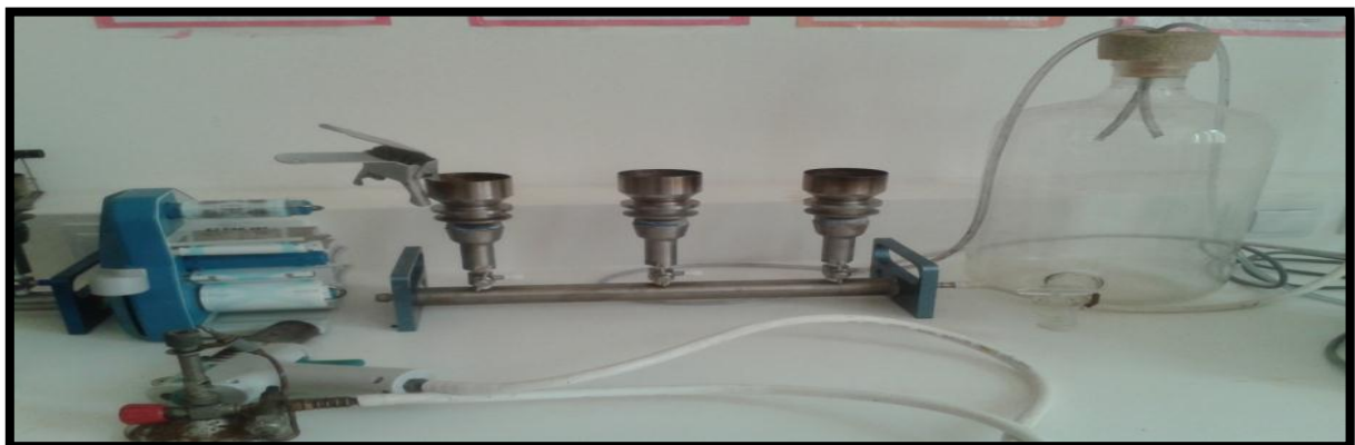
Rampe de filtration
