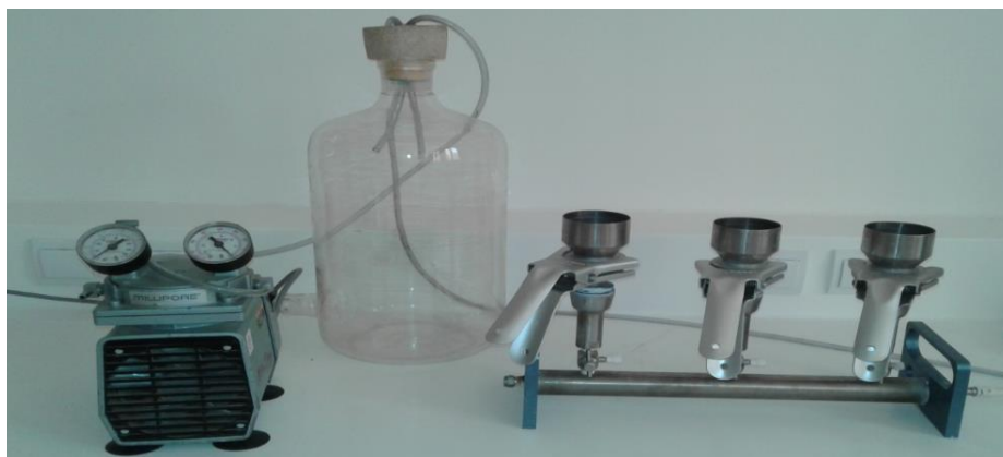
Figure 07 : La rampe de filtration (photo original)
