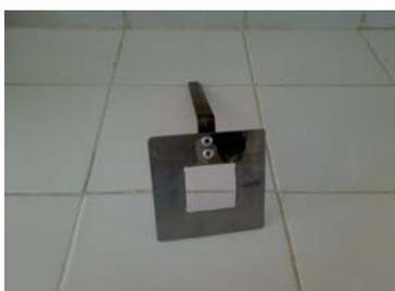
Figure 4.8 : Gabarit pour l'écouvillonnage de la paroi et trou d'homme (Photo personnelle).
