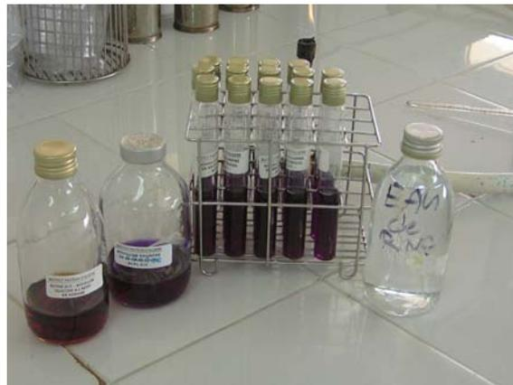
Figure 4.15 : Analyse d'eau de rinçage (Photo personnelle)
