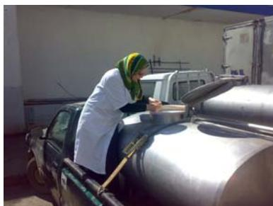
Figure 4.6 : Ecouvillonnage de la paroi supérieur (Photo personnelle)
