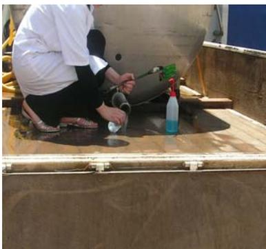
Figure 4.3 : Prélèvement d'eau de rinçage (Photo personnelle).
