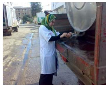
Figure 4.7 : Ecouvillonnage de la vanne de vidange (Photo personnelle).
