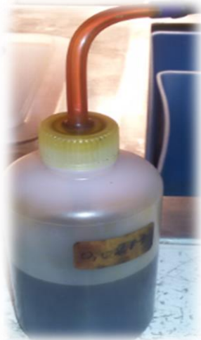
Figure II.15: la passivation permanente avec l'iode éthanol de l'échantillon.
