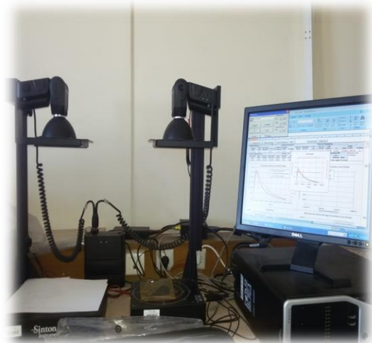
Figure II.16: la caractérisation de la durée de vie par QSSPC.
