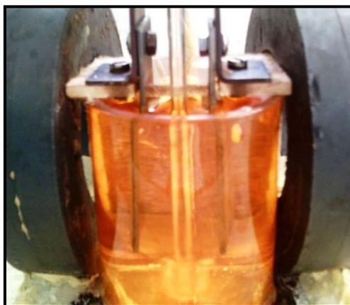
Figure 4.3 : le montage de traitement de la solution par le processus d'EC-CM
