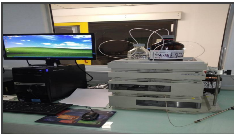
Figure III.1 : Schéma d'une installation de CLHP.
