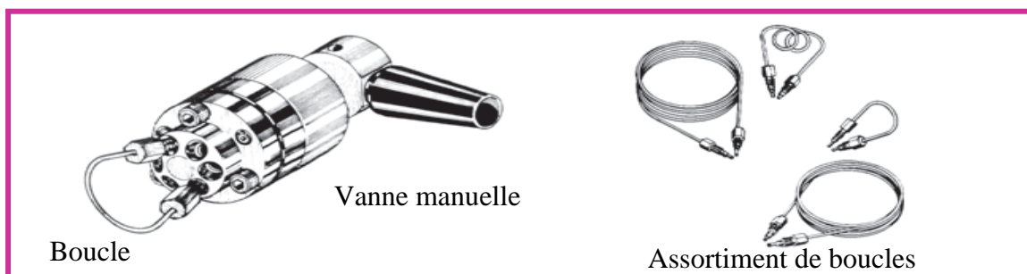
Figure III.4 : Vanne d'injection pour CLHP et boucles assorties [116].
