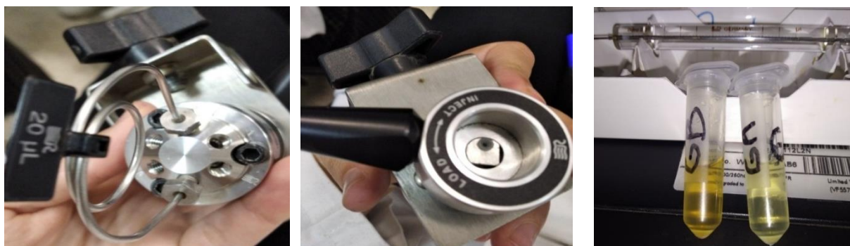
Figure VI.2 : La boucle d'injection utilisée dans l'analyse de l'échantillon.
