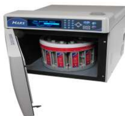
Figure 2.2 : Photographie du four à micro-ondes MARS-S (A) vue externe), (B) vue interne.
