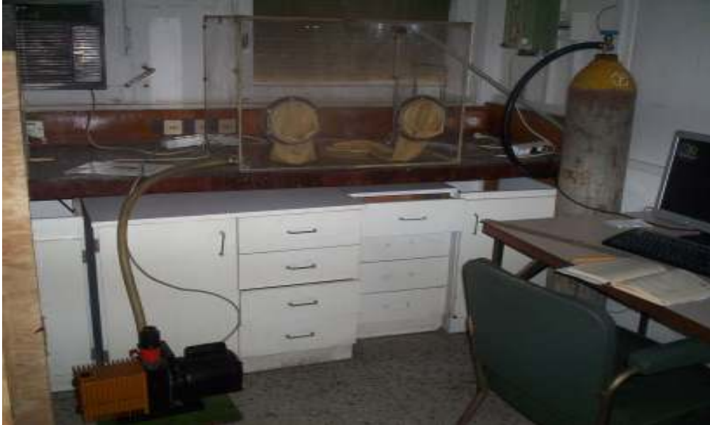
Figure 2. 3 : Boite à gants, raccordée à une bouteille d'argon et à une pompe primaire.
