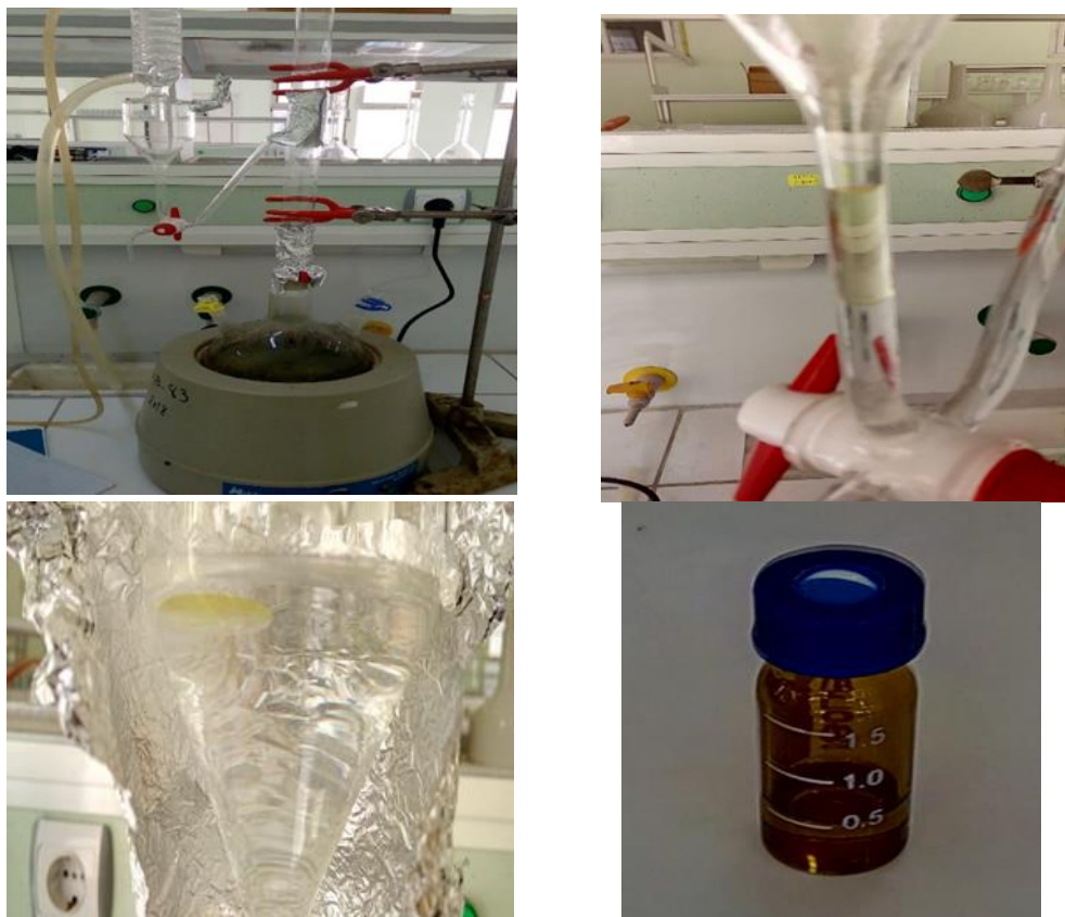
Figure II.5 : Dispositif d'extraction par hydrodistillation de type clevenger
